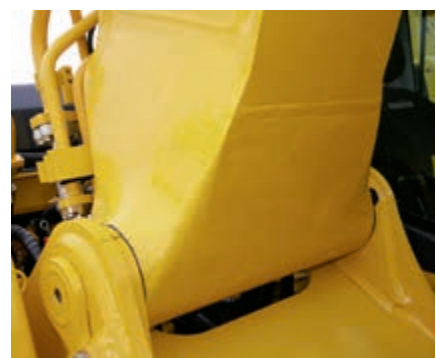
Støbt bomfod og bomplader i ét stykke for maksimal beskyttelse
