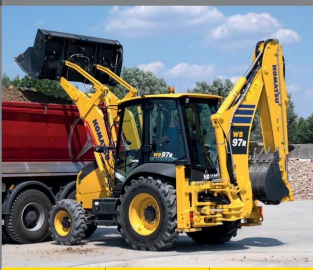
ENGINE POWER 75 kW / 101 HP @ 2.300 rpm **OPERATING WEIGHT** 7.310 - 9.020 kg
