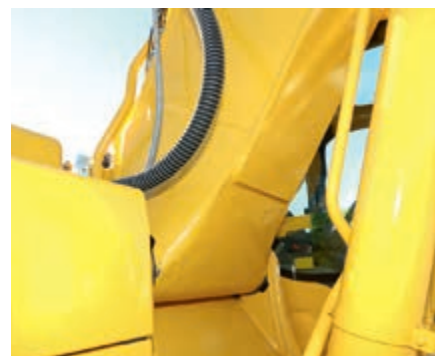
Støbt bomfod og bomplader i ét stykke
