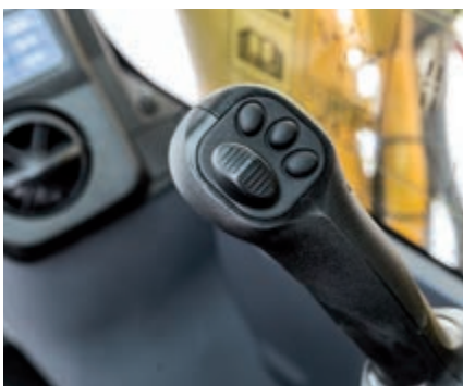
Praktisk, ergonomisk og præcis styring: joysticks med knap til proportionalstyring af redskaberne
